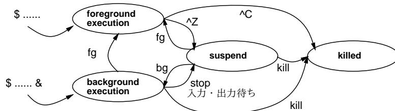
図 7.11: ジョブコントロールの状態遷移
