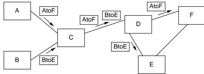
図 2.3: パケット交換の原理
