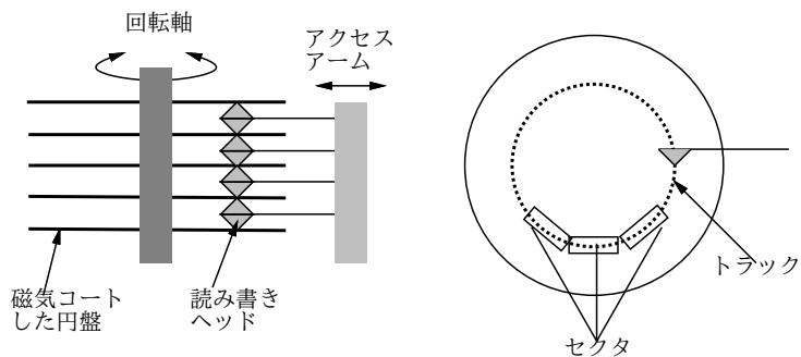
図 5.1: 磁気ディスク装置の構造
