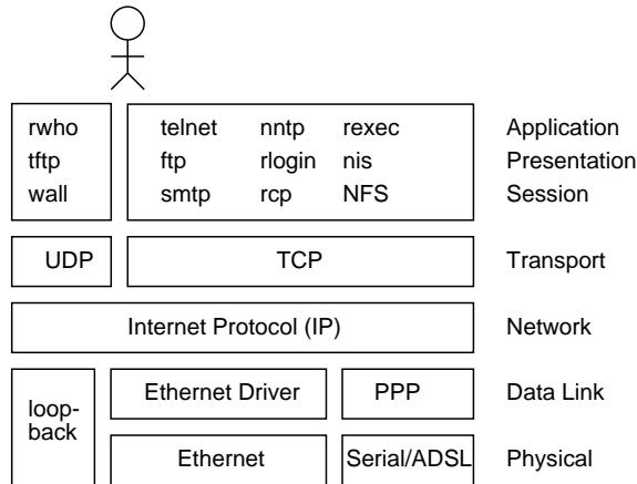
図 2.6: TCP/IP のプロトコル構成
