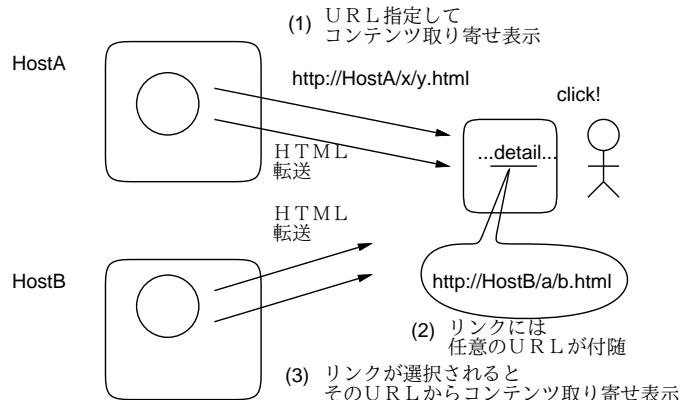
図 3.5: リンクの仕組み
