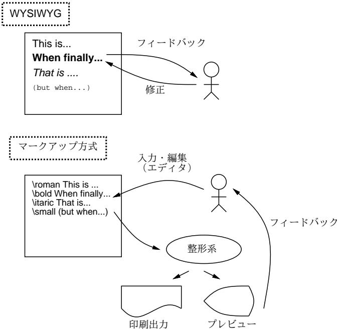
図 9.4: WYSIWYG 方式とマークアップ方式
