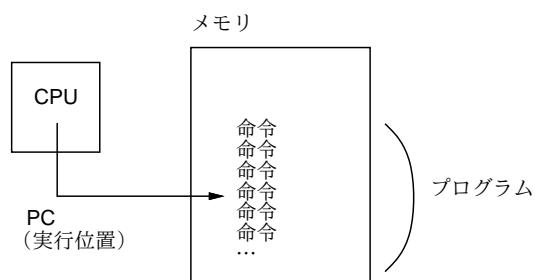
図7.6: CPUによる命令の実行
