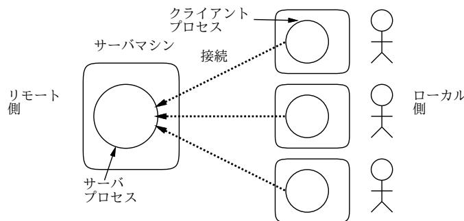
図 3.4: クライアントサーバ方式
